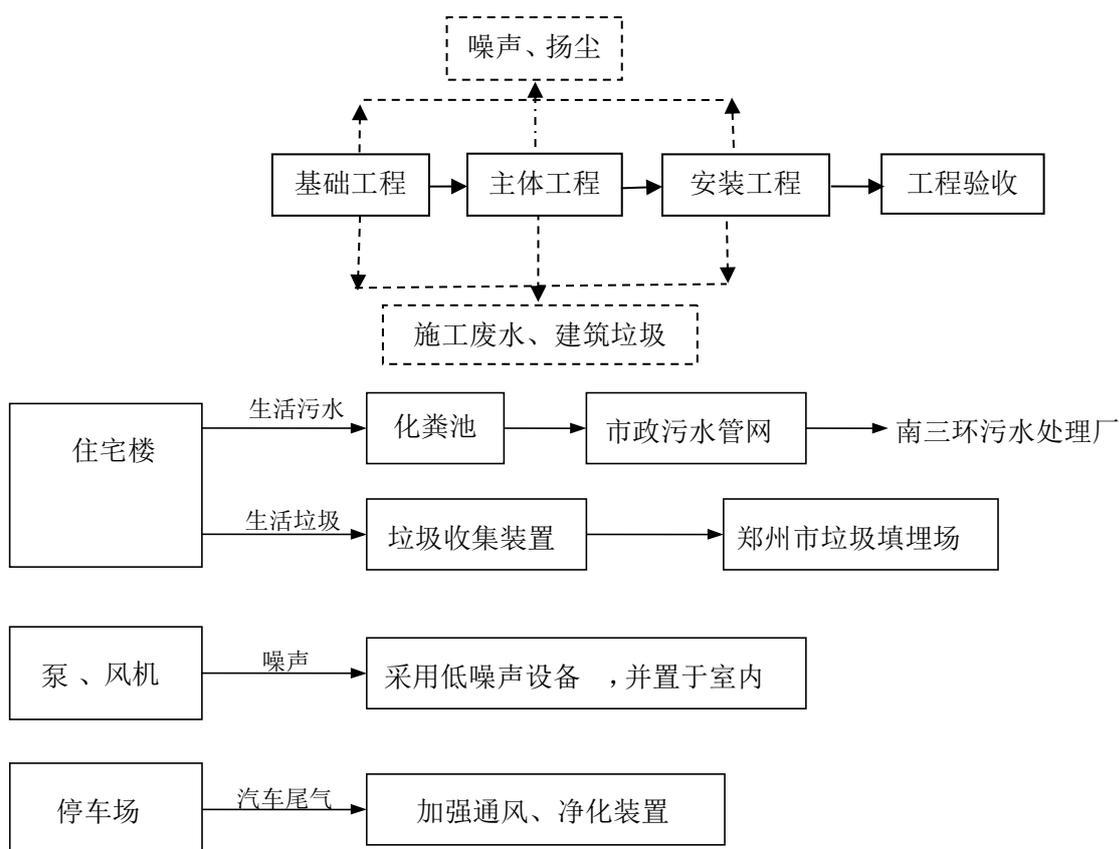
图 3 基本工序及产污环节示意图
