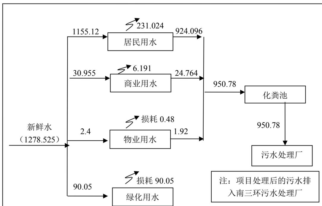
排水：本项目采用雨、污分流排水系统。雨水经项目区雨水管网收集后排入市政雨水管网；项目生活污水经化粪池处理后排入市政污水管网，然后排入南三环污水处理厂处理（污水收水范围图见附图五）。
